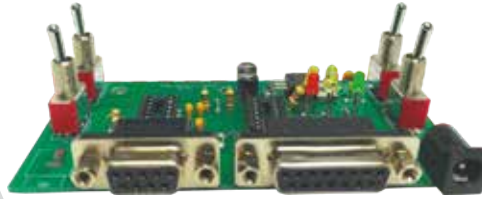
TÜRK HAVA YOLLARI KOLTUK PANELİ TEST CİHAZI
